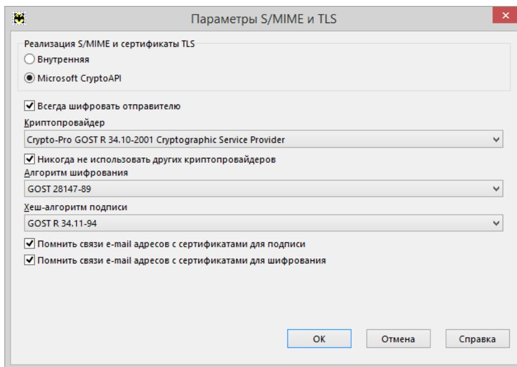
Рисунок 159. Настройка параметров S/MIME и TLS
